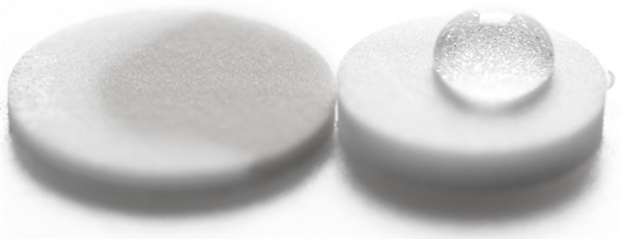
疏水性筛板，必需加压，否则水滴不能渗入筛板。
