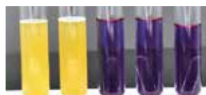
L 品牌乳糖胆盐发酵培养基-大肠埃希氏菌 ATCC25922-金黄色葡萄球菌 ATCC6538-空白对照
