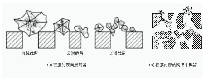
微滤膜各种截留作用的示意图
