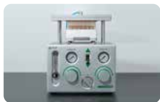
步骤 2 采用 biocomma®24 孔正压提取装置进行正压过滤，样品瓶置于进样瓶托盘中接收样本。
